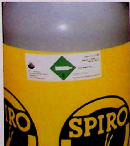
Aufkleber an der Flasche dürfen die eingeschlagenen Markierungen nicht verdecken.
