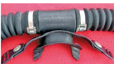
Einfaches Gummi-Mundstück für den Zweischlauchregler Mistral von La Spirotechnique
