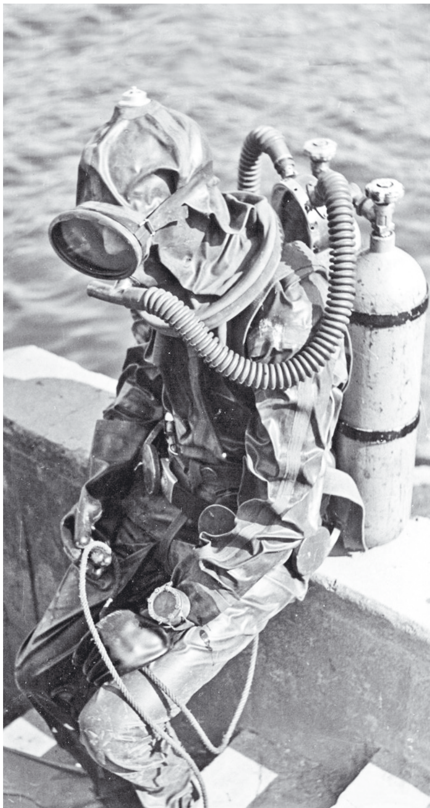
Links: Tauchen mit dem selbstgebauten Sauerstoff-Kreislaufgerät und Harpune für die Selbstversorgung
